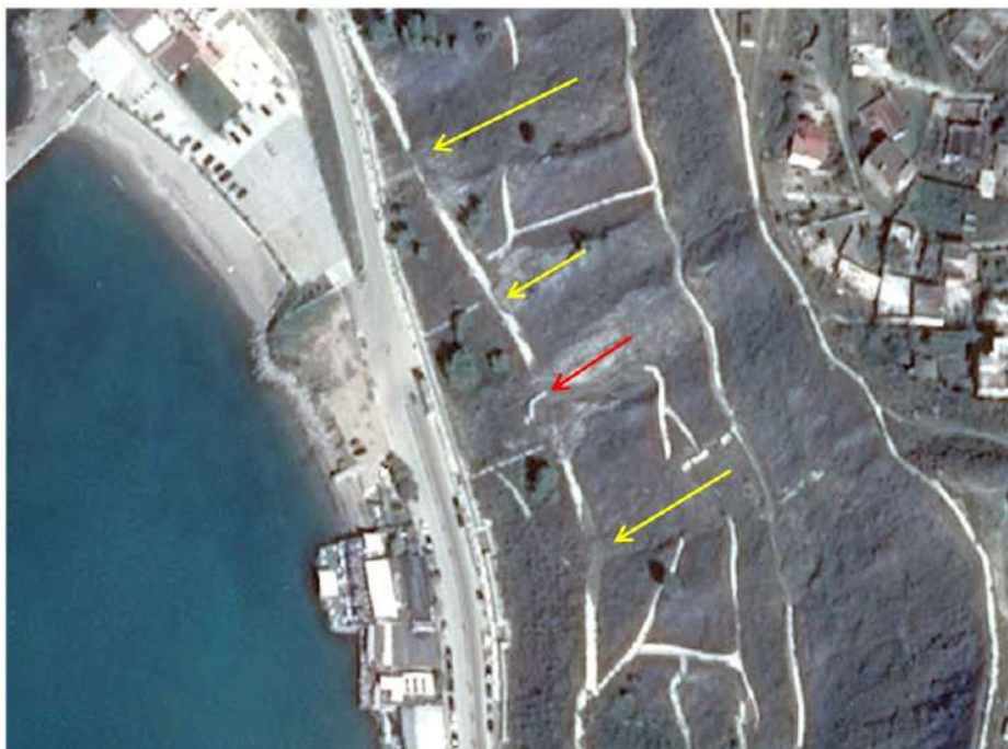
Figura 5.7: Foto ajrore e vitit 2016 ku tregohet drejtimi i rrëshqitjeve të para që shfaqen në shpat pas stabilizimit të 2015.
