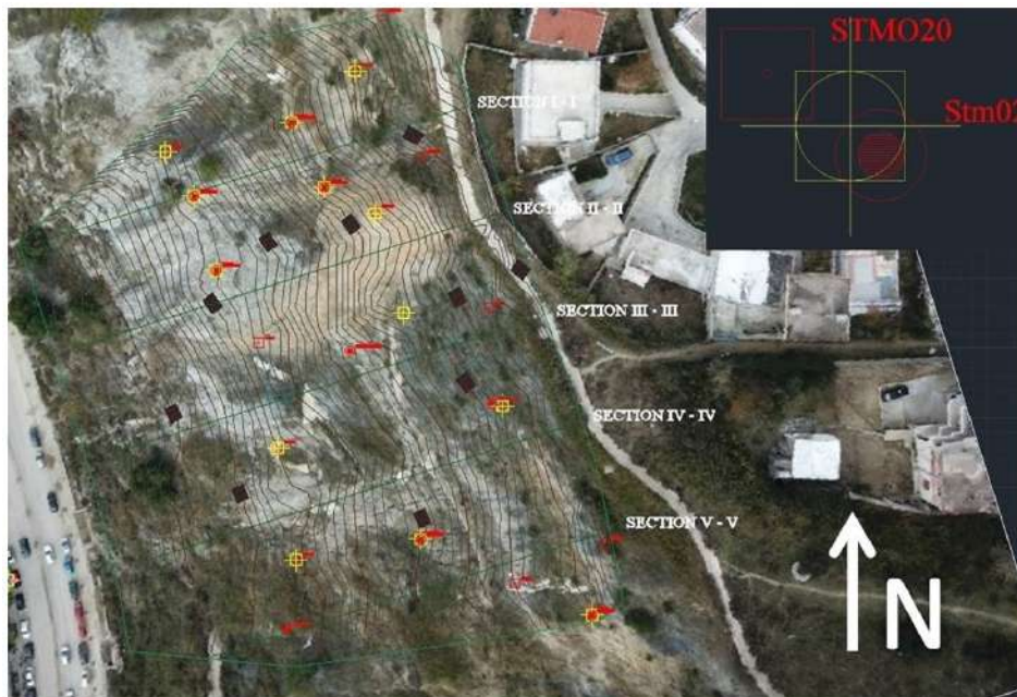
Figura 5.10: Seksionet e prerjeve tërthore të kodrës së Currilave dhe piketat e monitorimit 2018-19
