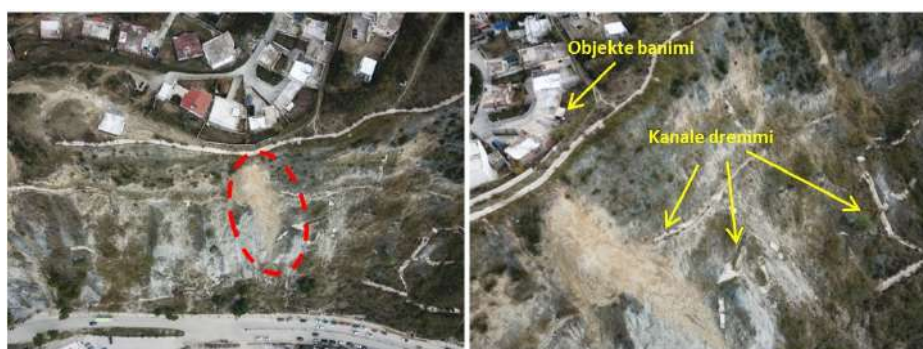
Figura 5.8: Foto me drone ku dallohen rrëshqitjet aktive pranë zonave të banuara dhe dëmtimet në kanalet e drenimit
