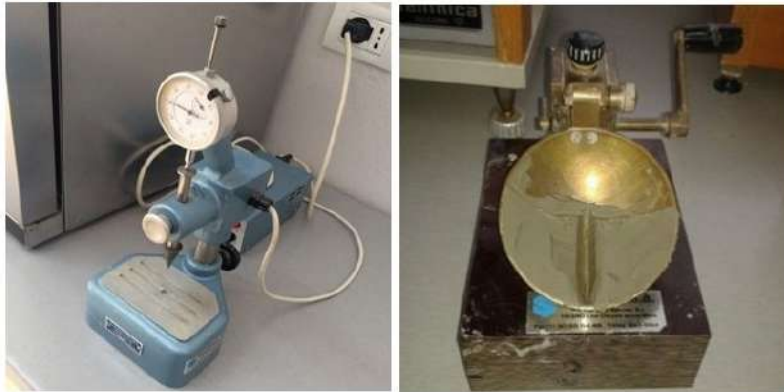
Figura 3.11: Aparati i rënies së konit (majtas) dhe luga e Casagrande-s (djathtas)
