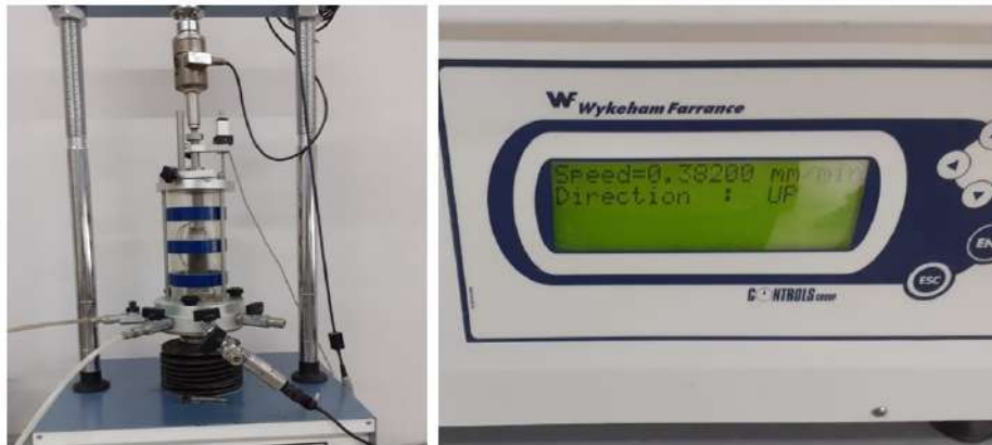
Figura 3.13: Qeliza e aparatit të triaksialit dhe shpejtësia e prerjes së kampionëve
