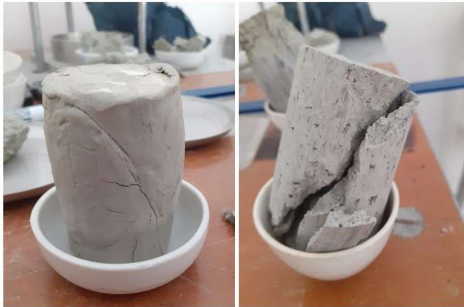
Figura 4.26: Deformimi dhe plani i këputjes për argjilën e ngjeshur të patrajtuar (majtas) dhe me 3.5Ç/8HQ (djathtas)
