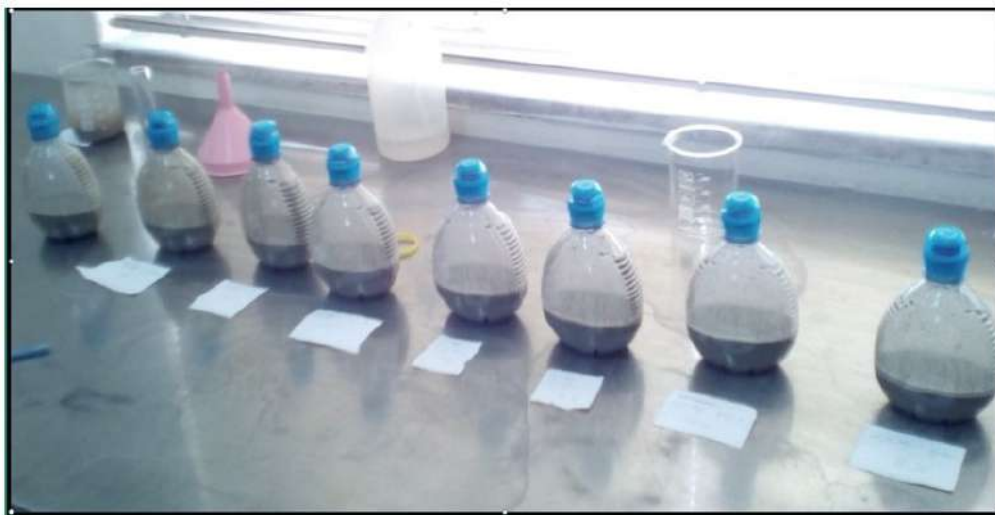
Figura 3.12: Shisheet me përqindje të ndryshme agjentësh kimikë përzier me argjilën
