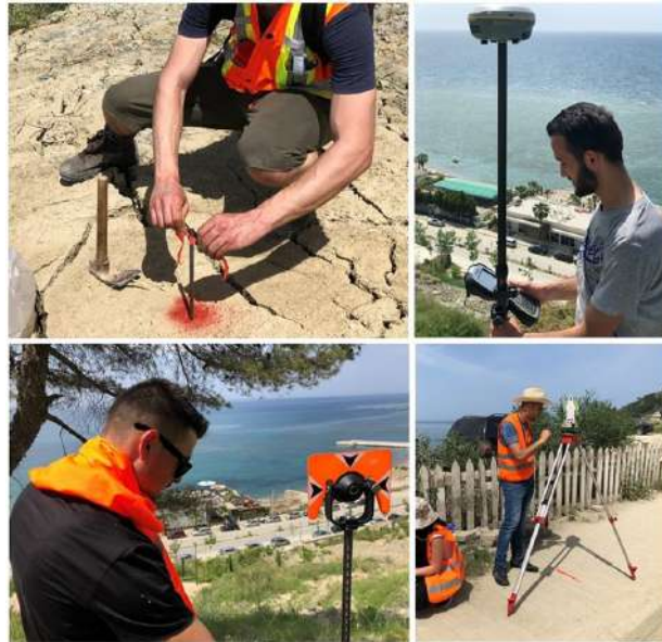
Figura 5.9: Procedura e monitorimit të shpatit përmes nguljes së piketave të hekurit dhe matjes së pikave me GPS dhe Total Station
